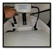
Figure 7.1.2 Removing Flange Bolt.
